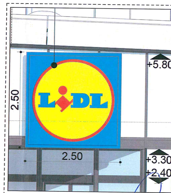
AMPLASARE CASETE LUMINOASE PE FATADE - DETALII scara 1:50
