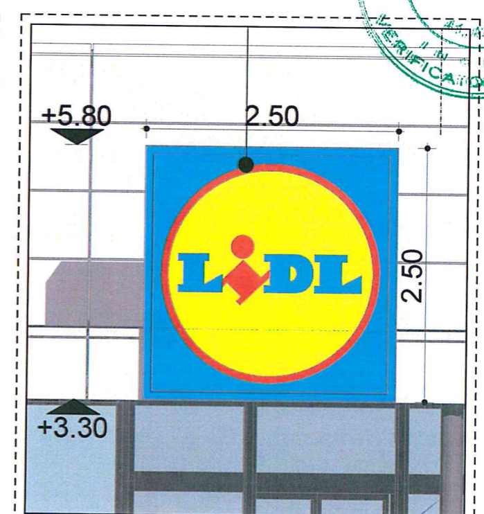
AMPLASARE CASETE LUMINOASE PE FATADE - DETALII scara 1:50
